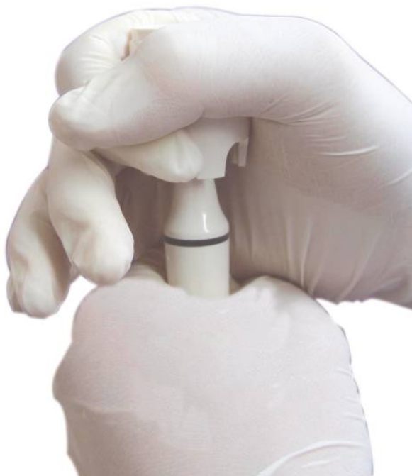
Rys. 4. Dokręcanie końcówki kluczem.
